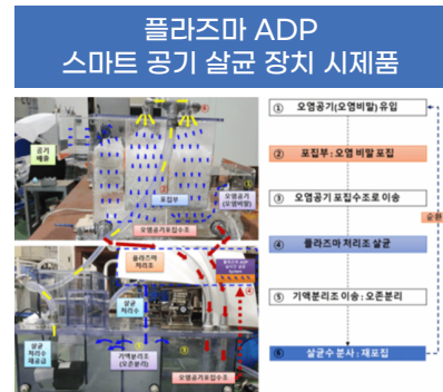
스마트 공기 살균 장치 작동 원리
